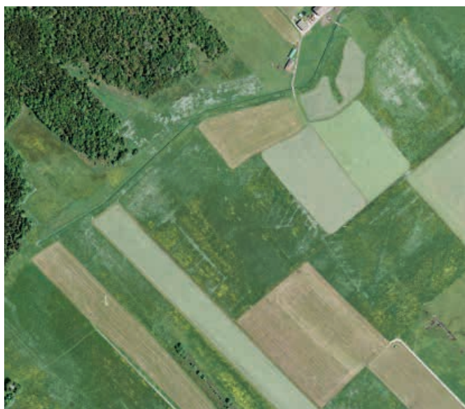
Fig. 38 Les drainages agricoles apparaissent clairement sur les vues aériennes.
